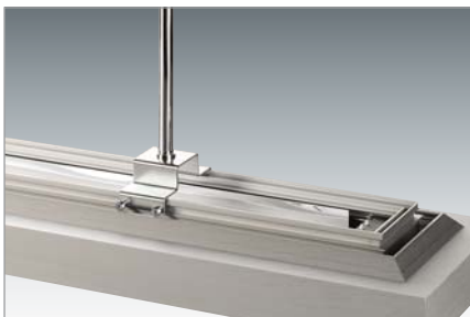
Rohrpendel. 2 Stück für 1-längige Leuchte, mindestens 2 Stück für 2-längige Leuchte, mindestens 3 Stück für 3-längige Leuchte.
