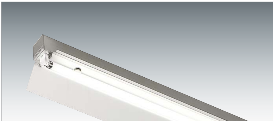
Reflektor-Anbau- und Pendelleuchte, Alu-Profil 40x40mm farblos eloxiert. Die 2- und 3-längigen Leuchten enthalten eine Durchgangsverdrahtung 5x1,5mm 2 . Reflektor Aluminium matt.
